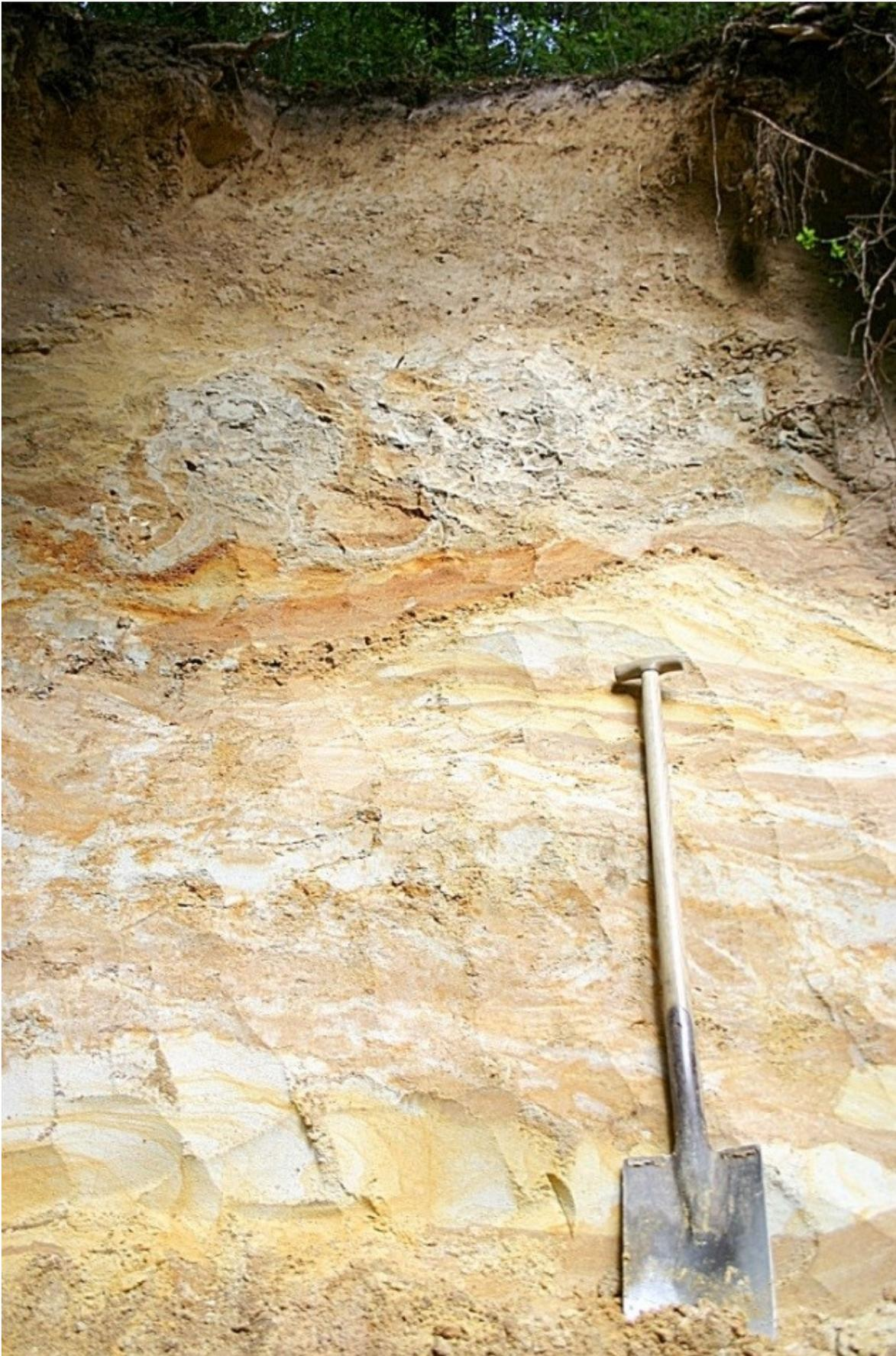
Abb. 211-01: Lösslehmhaltige Solimixtionsdecke über Kryoturbationshorizont auf verwitterten Stubensandstein-Schichten (Löwenstein-Formation, Keuperbergland; Foto: LGRB Baden-Württemberg)
