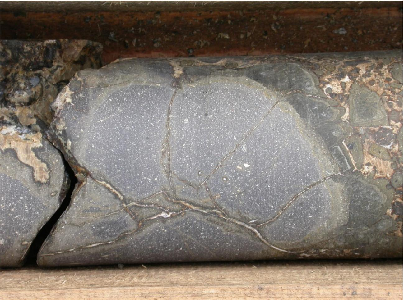
Abb. 319-03: Pillow mit alterierter ehemaliger Glaskruste (dunkelgrün) und typischen Speichenrissen, eingebettet in eine Matrix aus Hyaloklasten. Ehemaliger Interpartikelraum mit Tonmineral-Zement ("Bolus") gefüllt. Durchmesser des Bohrkerns 10 cm. (Bohrung Nidda-Liebhölzchen, 78,8-78,95 m; SE Steinbruch Nidda, HE; Foto: H.-D. Nesbor, HLNUG, 2010).
